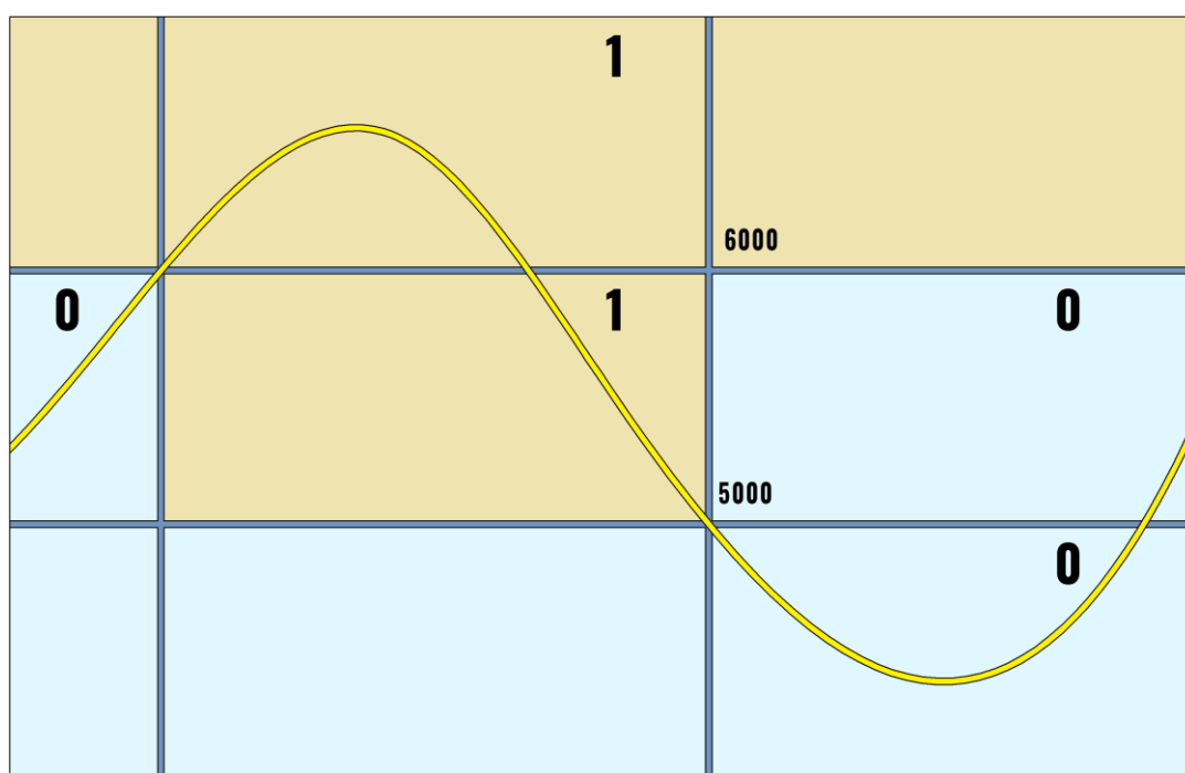
Рисунок 2.15 Преобразование аналогового сигнала в дискретный
