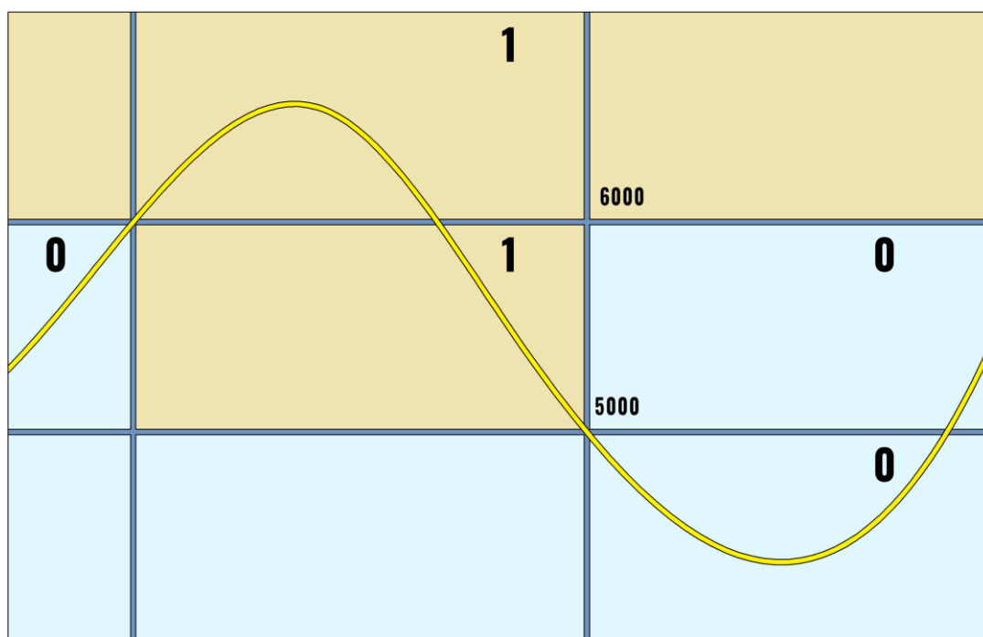
Рисунок 2.11 Преобразование аналогового сигнала в дискретный
